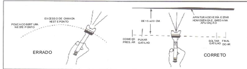
**CUIDADO:** Para evitar o excesso de pintura, pode ser regulada a vazão da pistola a través do regulador de fluido.
